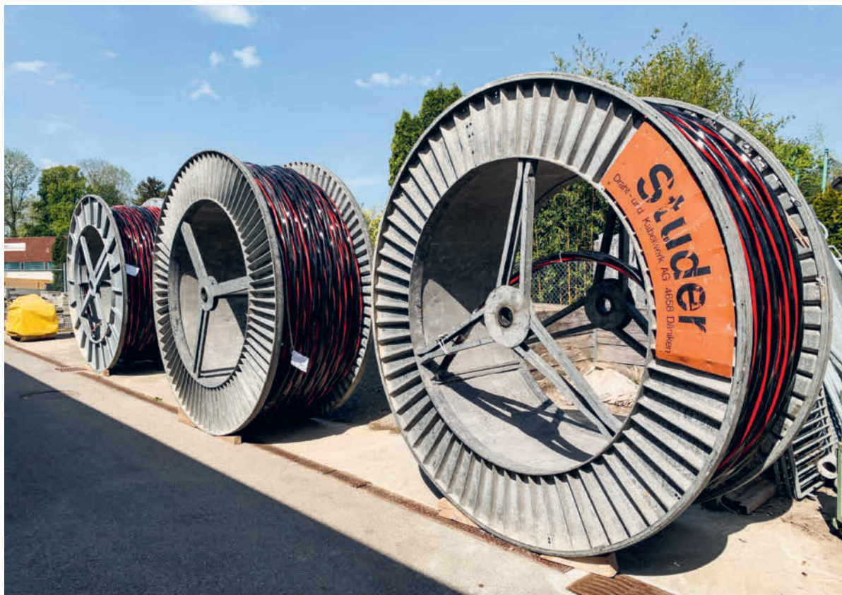
Mittelspannungs-Kabelrollen / Quelle TB Waldkirch
