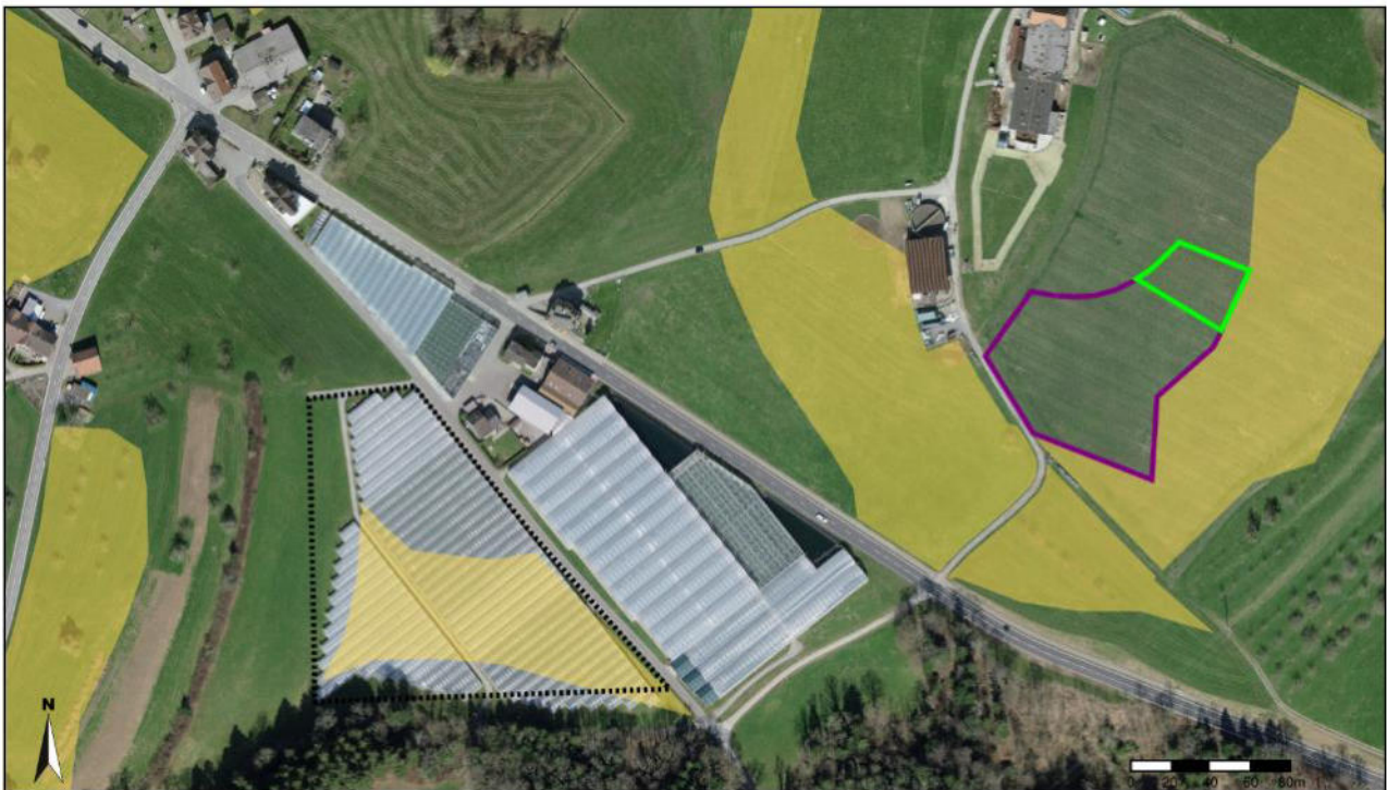
Abbildung 1 Projektübersicht Bodenabtragsperimeter (schwarz), FFF-Kompensationsfläche mit Bodenauftrag (violett), anrechenbare Bodenfläche ohne Bodenauftrag (grün)
