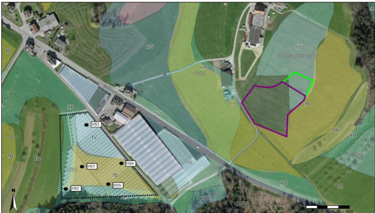
Abbildung 2 Bodeninformationen mit Handsondierstandorten Abtragsperimeter (schwarz); Kompensationsperimeter mit Bodenauftrag (violett), Kompensationsperimeter ohne Bodenauftrag (grün)
